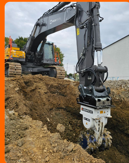
Der 75-Tonner wurde in Absprache mit dem Verkaufsberater von KEMROC mit einer Querschneidkopffräse EKT 220 bestückt.
