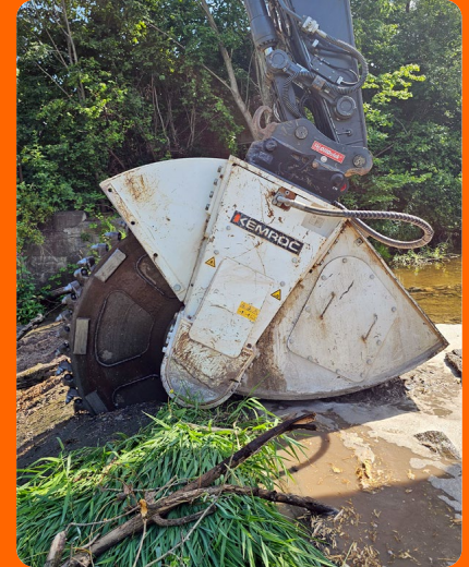
Das KEMROC-Schneidrad in der Nahaufnahme. Seine Schneidgarnitur entfernt nur so viel Substanz von der Betonstruktur, wie für einen sauberen Schnitt notwendig ist.
