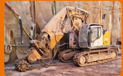
Kräftig und gedungen wirkt der Liebherr R 960 Tunnel. Er ist mit rund 50 Tonnen Einsatzgewicht rund 6 Tonnen schwerer als das Vergleichsmodell R 944 Tunnel.
